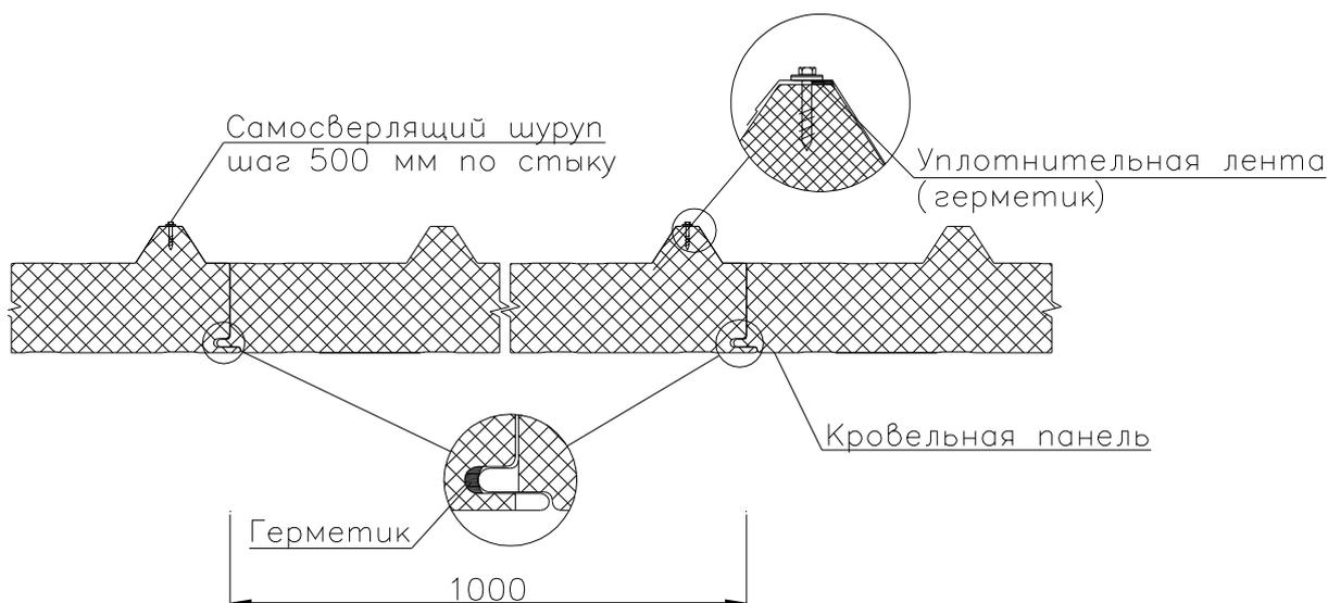
Рис.21. Соединение кровельных панелей с высоким гофром
